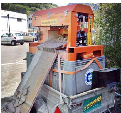
Einsatz der Schlammpresse bei Schulhaus-Umbau
