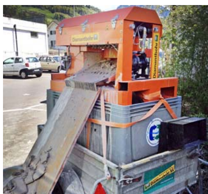
Utilisation de la presse à boue dans la construction d'une école
