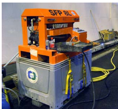
Utilisation de la presse à boue dans le Tunnel de Gubrist/ZH
